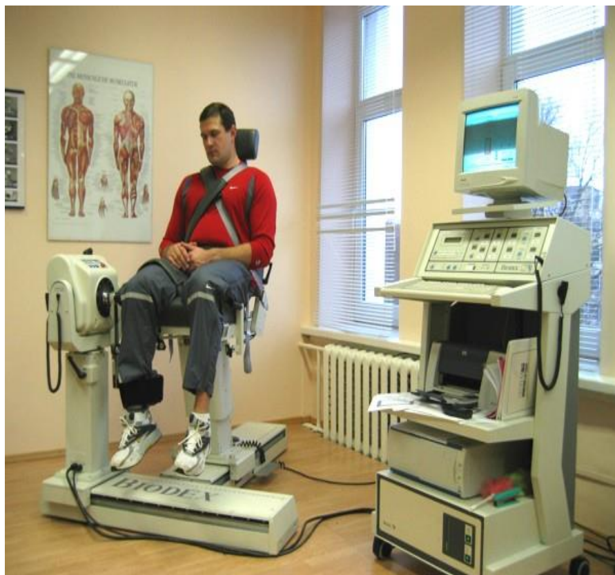
42 pav. Blauzdos tiesimo ir lenkimo kinematinų ir dinaminių charakteristikų registravimas izokinetiniu dinamometru
