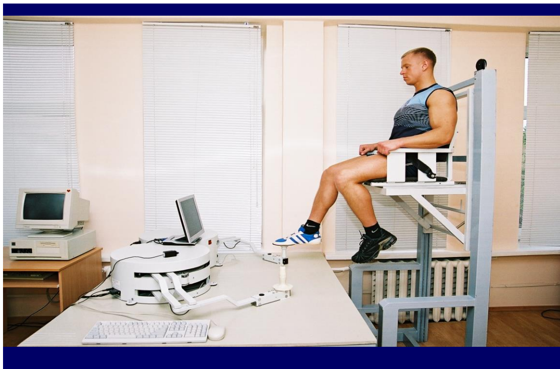
44 pav. Kojų judesių tikslumo ir greitumo tyrimas DPA-1 prietaisu (pagamintas Baltec Sport)
